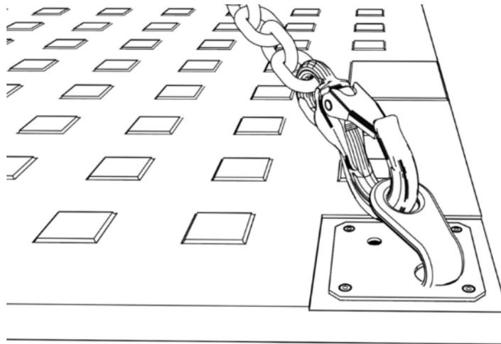
Durch Anheben des Kettengehanges kann die Platte in die gewünschte Position bewegt und verlegt werden.
