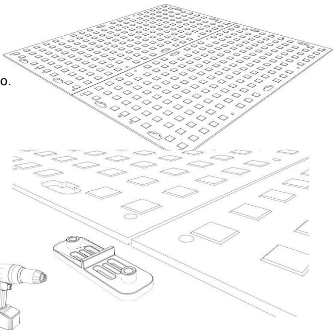
Za spajanje ploča jednostavno umetnite priključke ispod ploče i pričvrstite ih vijkom i podloškom M10x25 odozgo.
