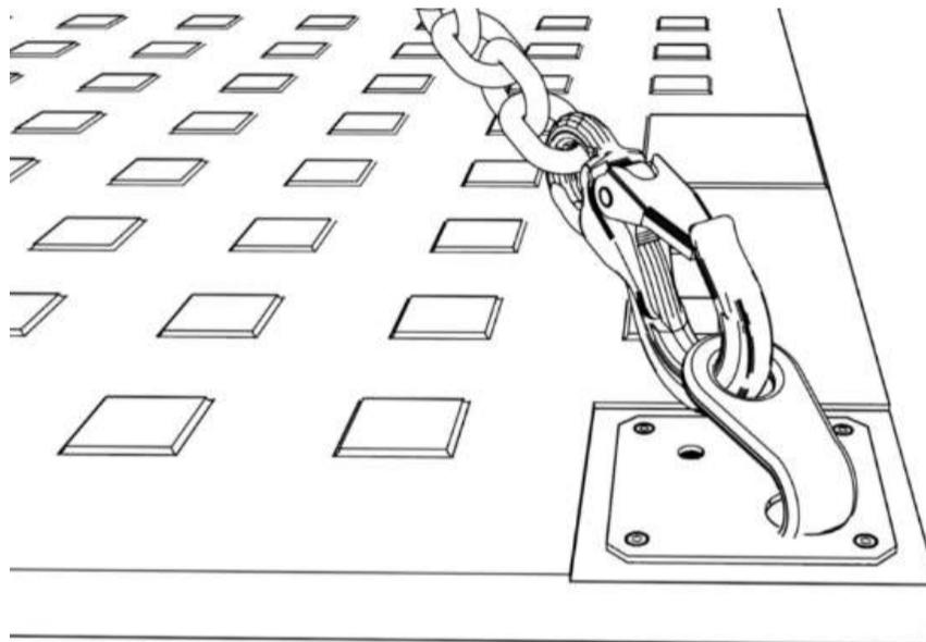
Durch Anheben des Kettengehänges kann die Platte in die gewünschte Position bewegt und verlegt werden.
