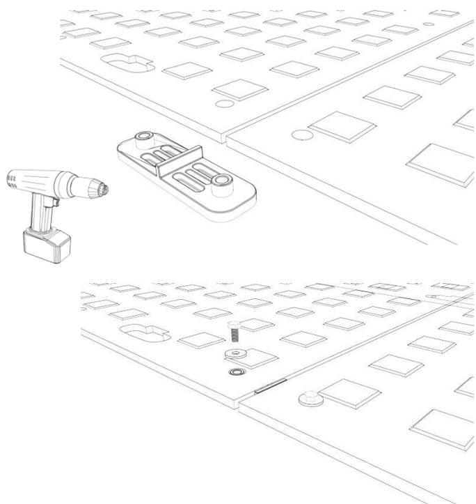
Wenn die Panels miteinander verbunden werden, entsteht eine zusammenhängende stabile Fläche, welche den Untergrund schützt und die Drucklast beim Befahren optimal verteilt.
