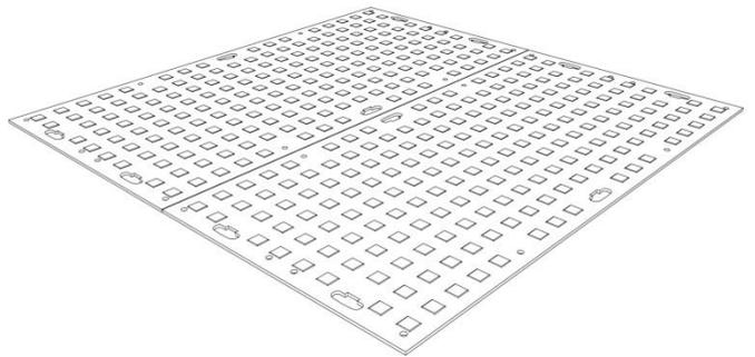
Um die Panels zu verschrauben, einfach die Verbinder unter die Panels führen und anschließend von oben mit einer Schraube und Unterlegscheibe M10x25 sichern bzw. verschrauben.
