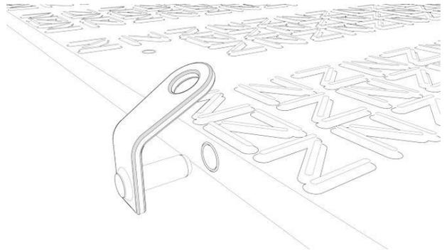
Durch Anziehen des Kettengehanges wird das Panel in die gewünschte Position transportiert bzw. verlegt, um es anschließend verschrauben zu können.
