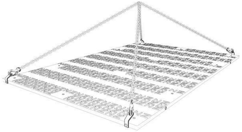
Lastenaufnahmehaken in die seitlichen Lastaufnahmeösen stecken, um das Panel in Verbindung mit einem Kettengehänge optimal bewegen zu können und es in die gewünschte Position zu bringen.
