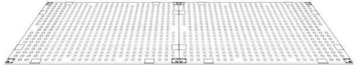
Das Panel ist von beiden Seiten einsetzbar. Die Oberseite ist mit leichten Profilen ausgelegt. Die Unterseite ist stark profiliert und für den Einsatz von Baufahrzeugen optimiert.
