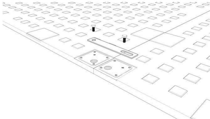
Bei der Verlegung ist darauf zu achten, dass die Panels einheitlich mit der gleichen Profilierungsseite nach oben verlegt werden.
