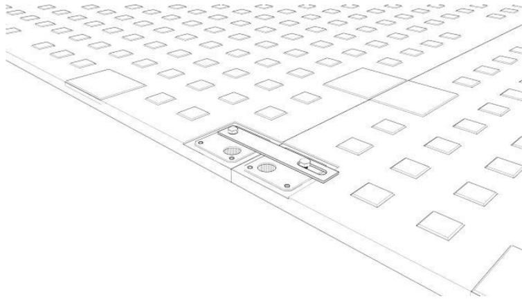
Coloque y atornille los paneles juntos para crear la carretera de tracción o plataforma de trabajo deseada.
