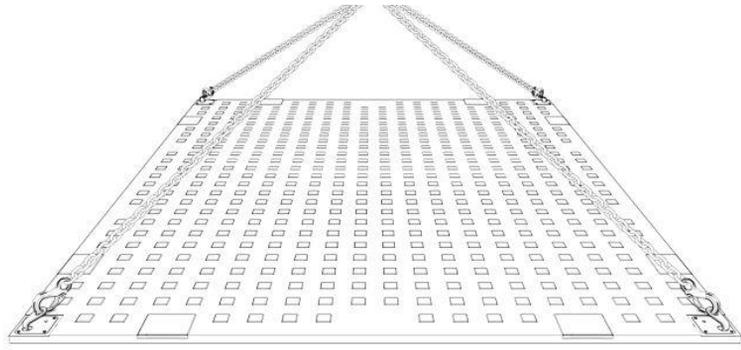
Inserte los ganchos de elevación en los ojales laterales para poder mover el panel de forma óptima en combinación con un dispositivo de suspensión de cadenas y colóquelo en la posición deseada.
