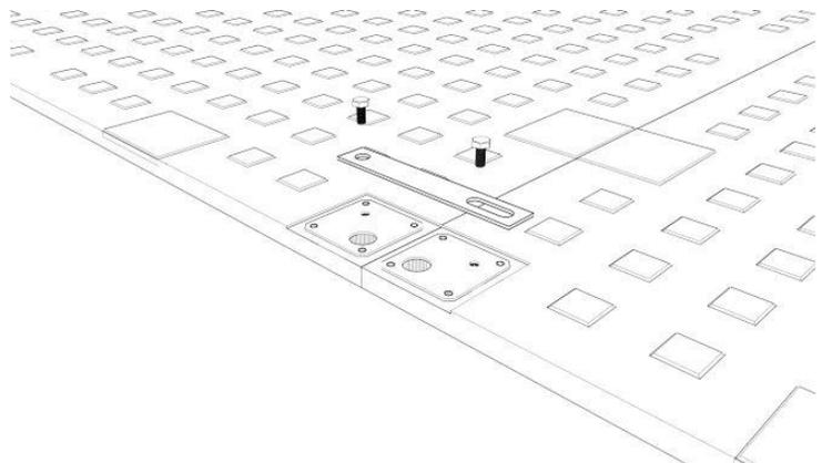
Al colocarlos, se debe garantizar que los paneles estén colocados de manera uniforme, con la misma cara del perfilado hacia arriba.
