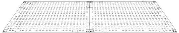
El panel se puede usar desde ambos lados. La parte superior está diseñada con perfiles ligeros, ideales para uso peatonal. La parte inferior está fuertemente perfilada y es óptima para el uso de vehículos de construcción.
